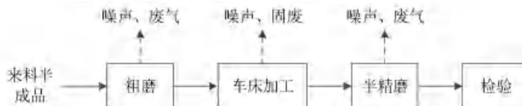
图 3-4 阀类零件加工工艺流程及产污环节图
